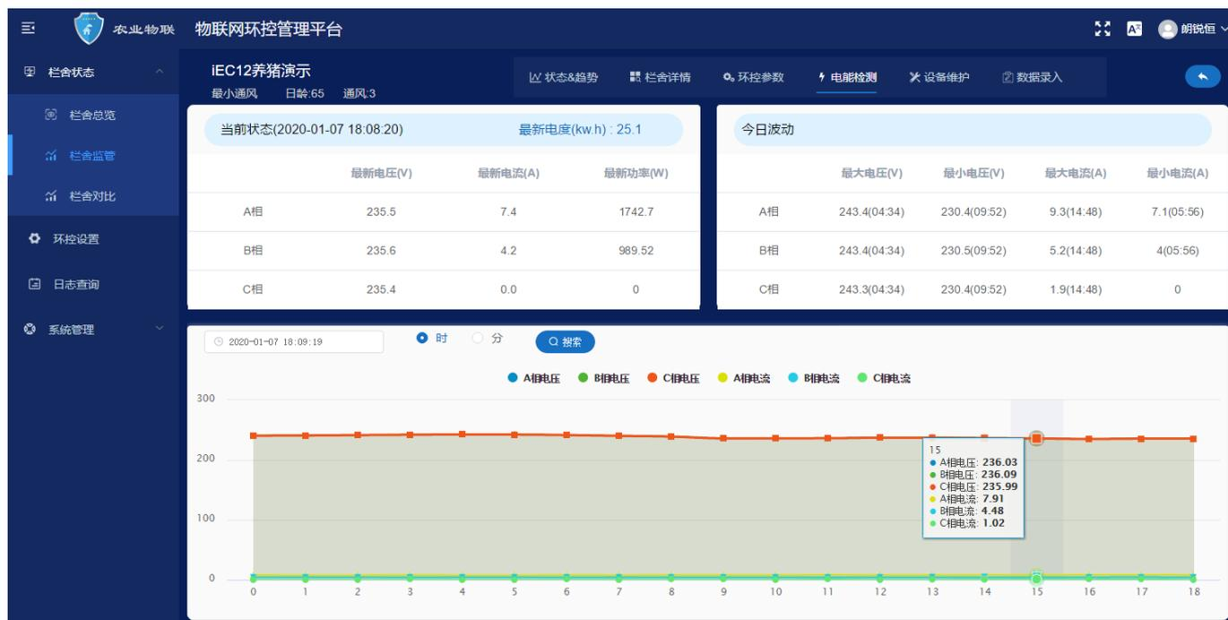
左上角显示当前实时的供电情况，包含数据获取时间，当前电表状态及当天电度值，同时显示当前 ABC 相电压与电流，功率为系统自动计算；
