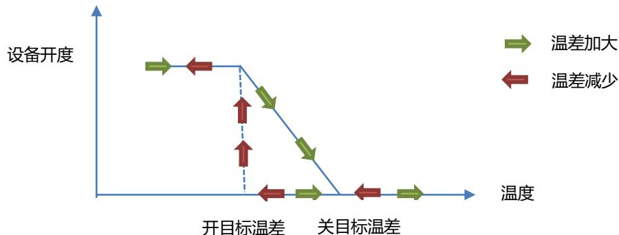
变频加热按照这个开度打开，加热根据开度乘以保温周期，计算间隔开关时间。
