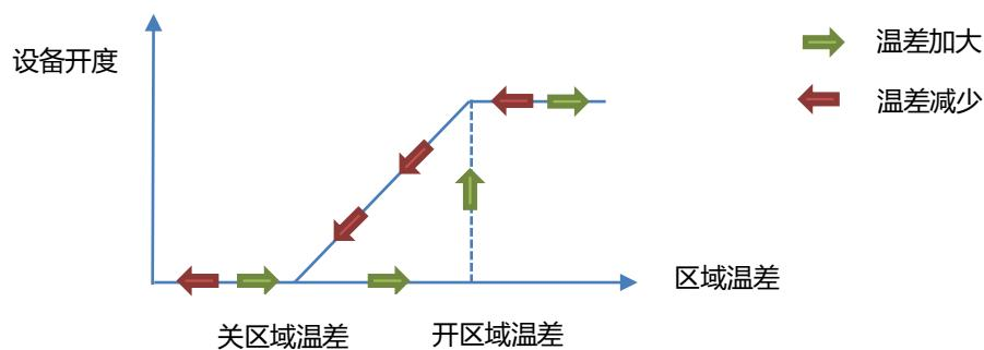
变频搅拌风机按照开度控制，搅拌风机根据开度乘以周期，计算间隔开关时间。
